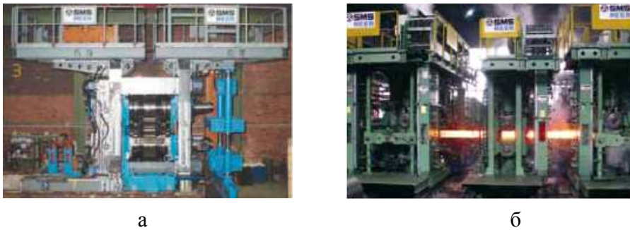
Рисунок 1.9 – Компактні касетні прокатні кліті CCR компанії «SMS Meer S.p.a.»: прокатна кліть дуо (а); реверсивна група клітей тандем (б)
