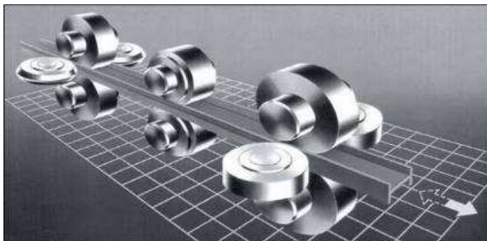
Рисунок 1.7 – Реверсивна група стану з послідовним розташуванням клітей (тандем) для прокатки за схемою X-H
